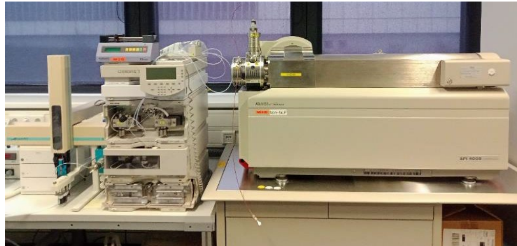
Abb. 4: Hochleistungsflüssigkeitschromatographie (Agilent Serie 1100) mit massenspektrometrischer Detektion (Triple-Quad-MS, API4000, SCIEX) (HPLC-MS 3 )
