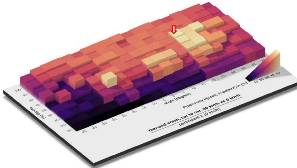
Für die betrachtete Variation existiert bislang kein Crashtest in Euro NCAP. Im Vergleich aller Pkw-Pkw-Heck-Situationen wurde eine Kollision mit 70% Offset und einem Winkel von 20° zur Fahrzeuglängsachse als kritisch eingestuft und mit einem roten Pfeil hervorgehoben. Diese Situation wird im folgenden Kapitel mit Situation D gekennzeichnet.
