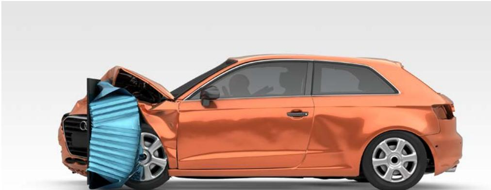
**Abbildung 2-6: Berechnung einer Kollision eines Pkw mittels FEM**
