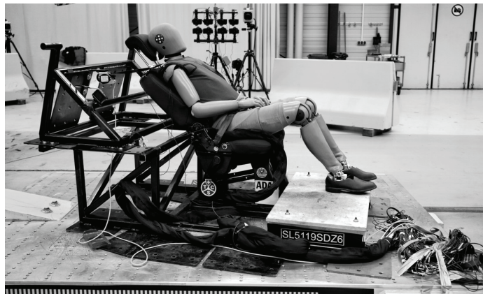
Abbildung 2: Versuchsaufbau der Schlittenversuche
