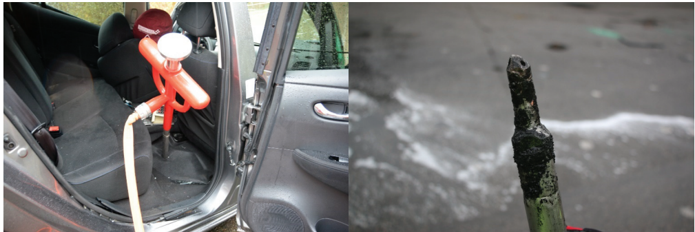
Abbildung 13: Eingeschlagene Lanze ohne Kurzschlussfolge und Lanzenspitze nach mehreren Versuchen
