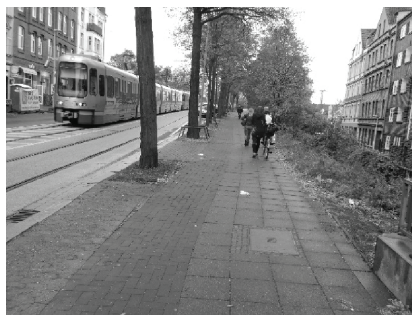
4. Einrichtungs-Radweg mit 1 m weit unter Mindestmaß (Hannover)
