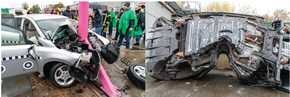
Abbildung 8: Deformation des Motorraums (84 km/h) und der Batterie (75 km/h)
