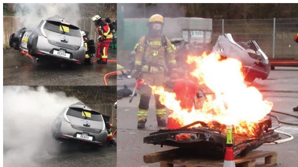
Abbildung 14: Einsatz von CO 2 in Kombination mit einem kleinen Einschlaginstrument und Vorbereitung eines Löschversuchs mit F-500 EA
