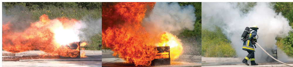
Abbildung 5: Brand- und Löschversuche mit Li-Ion-Antriegsbatterien
