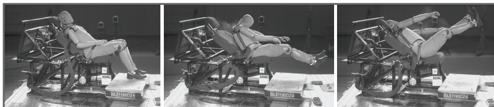
Abbildung 6: Schlittenversuch Nr. 3 in einer leicht gedrehten (15°) und liegenden Sitzposition
