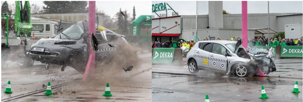
Abbildung 7: 90°-Pfahlanprall mit 75 km/h und Frontalanprall mit 84 km/h
