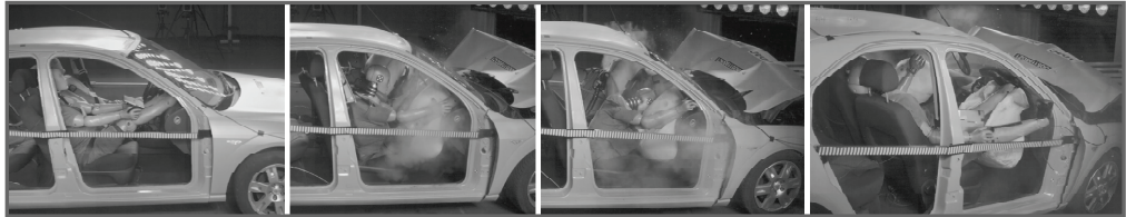
Abbildung 11: Crashphase des Beifahrers in Out-of-Position beim ODB Fahrzeugcrash
