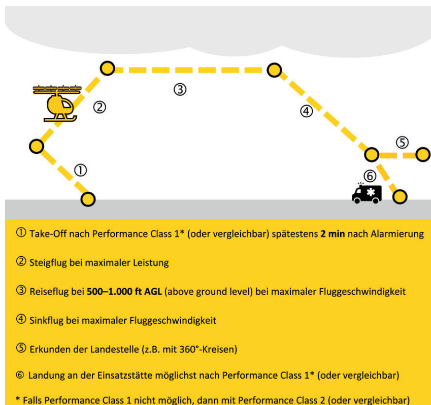
Abbildung 6.3: Schematisches Missionsprofil einer Multikopter-EMS-Mission nach heutigem Planungsstand
