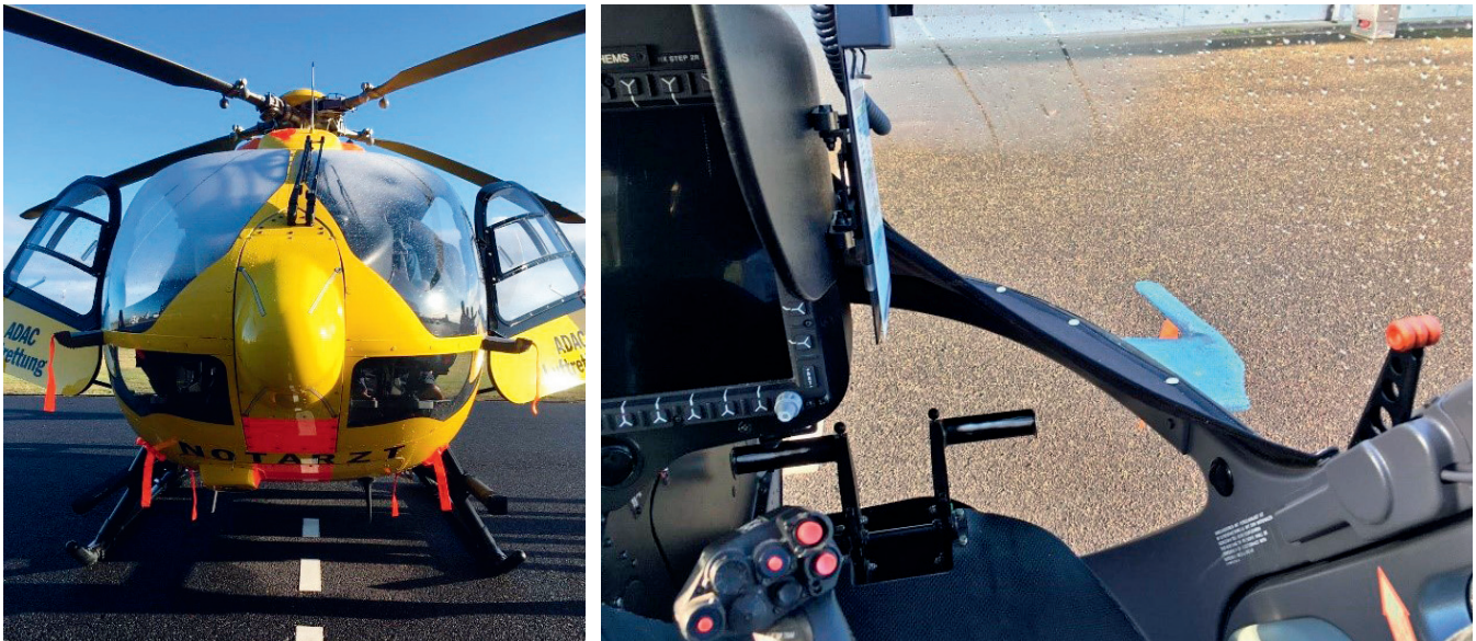
Abbildung 5.2: Sichtverhältnisse nach vorn/nach unten zur Landestelle am Beispiel der BK117 D2 (Quelle: ADAC Luftrettung)
